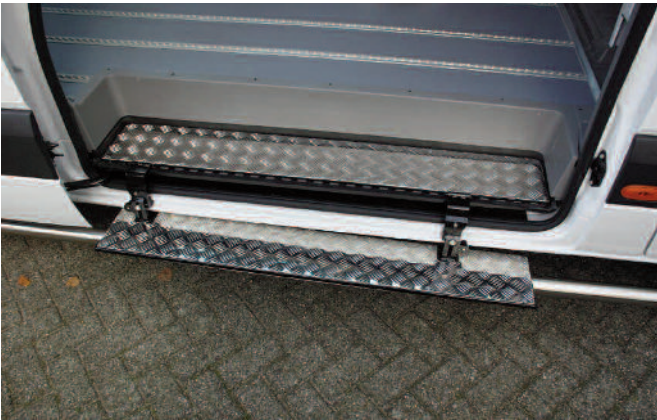
1. Als de trede is uitgeklapt dient deze als opstap
