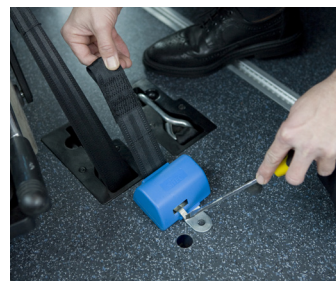
De voorste spanband ontgrendelt zo handmatig.
